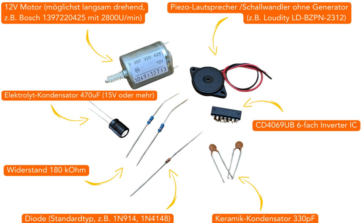
(Bild: Die 9 Bauteile des Motörbörds)
