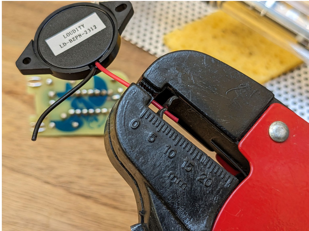
(Bild: Gekürzte Leitungen des Lautsprechers abisolieren)
